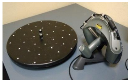
Fig. 12. Equipo de escáner 3D utilizado en la medición Marca Creaform ®.
