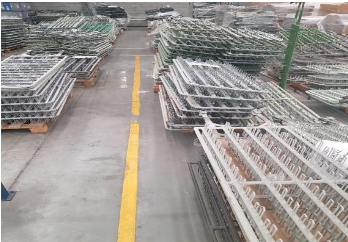
Figura 24 Racks de cromado desorganizados y dañados por el tipo de acomodo.
