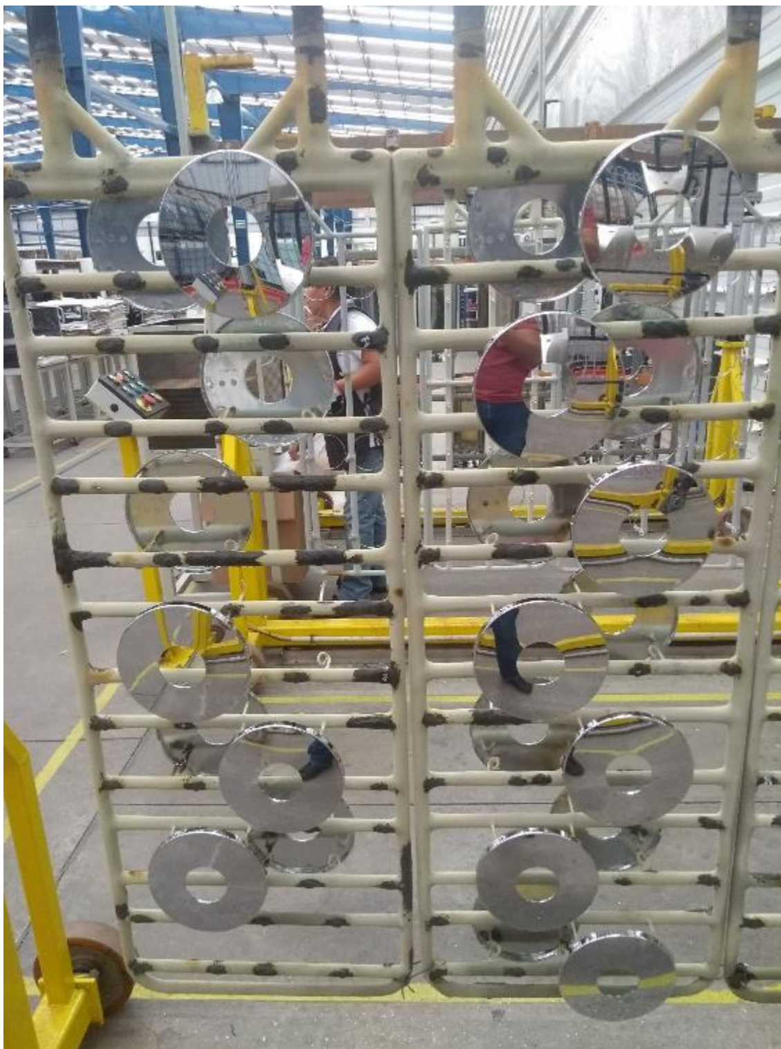
Figura 17 Racks con capacidad disminuida por caída de puntos de contactos y/o sujeción.
