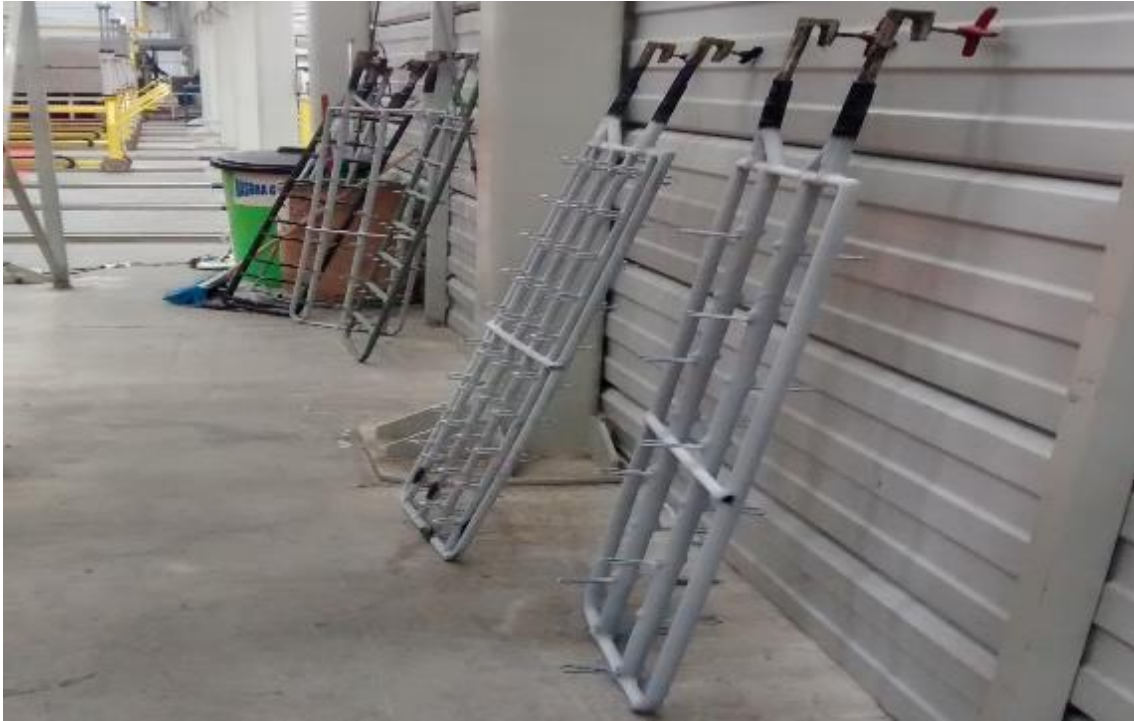
Figura 23 Racks sin un área de almacenamiento designada
