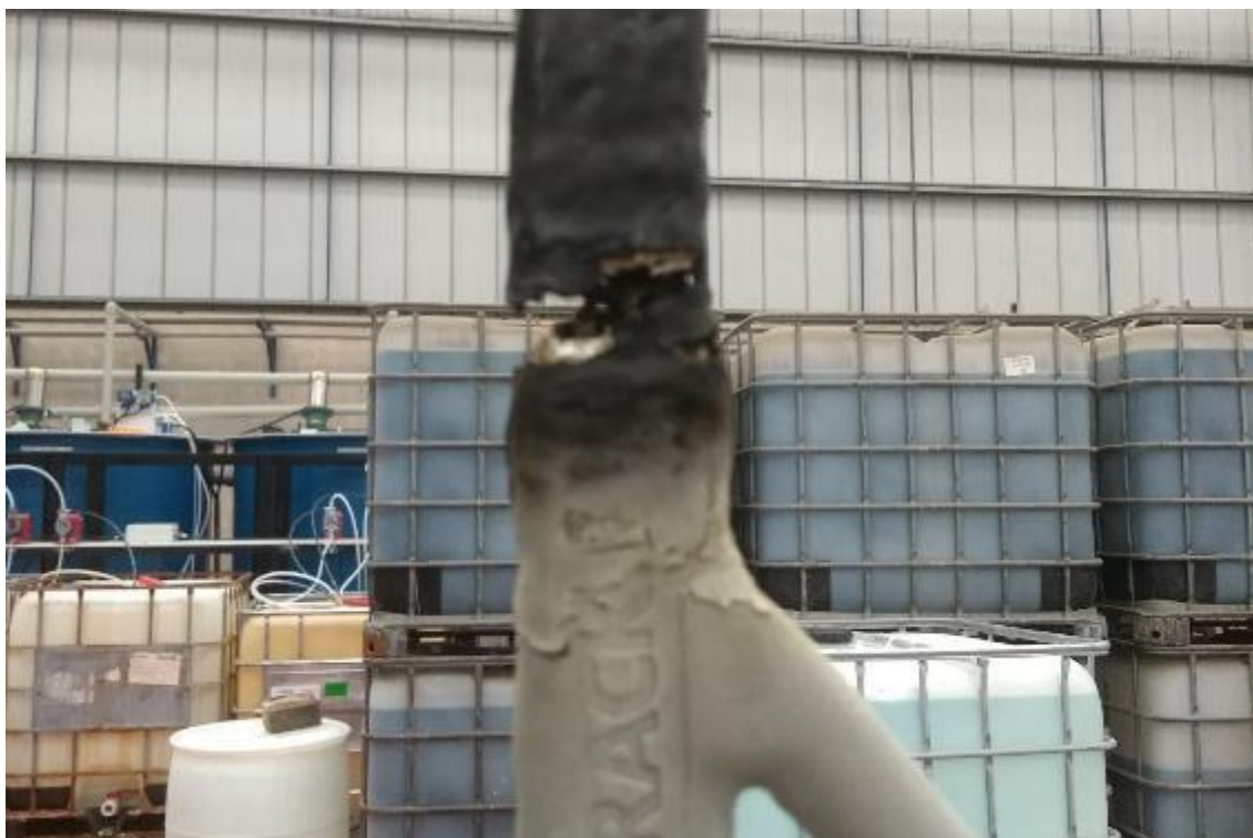
Figura 14 Degradación del plastisol.
