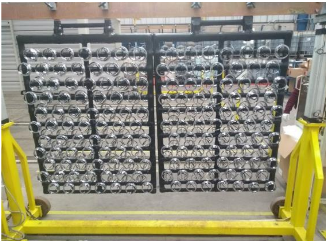
Figura 5 Rack de Cromado con piezas plásticas ya cromadas
