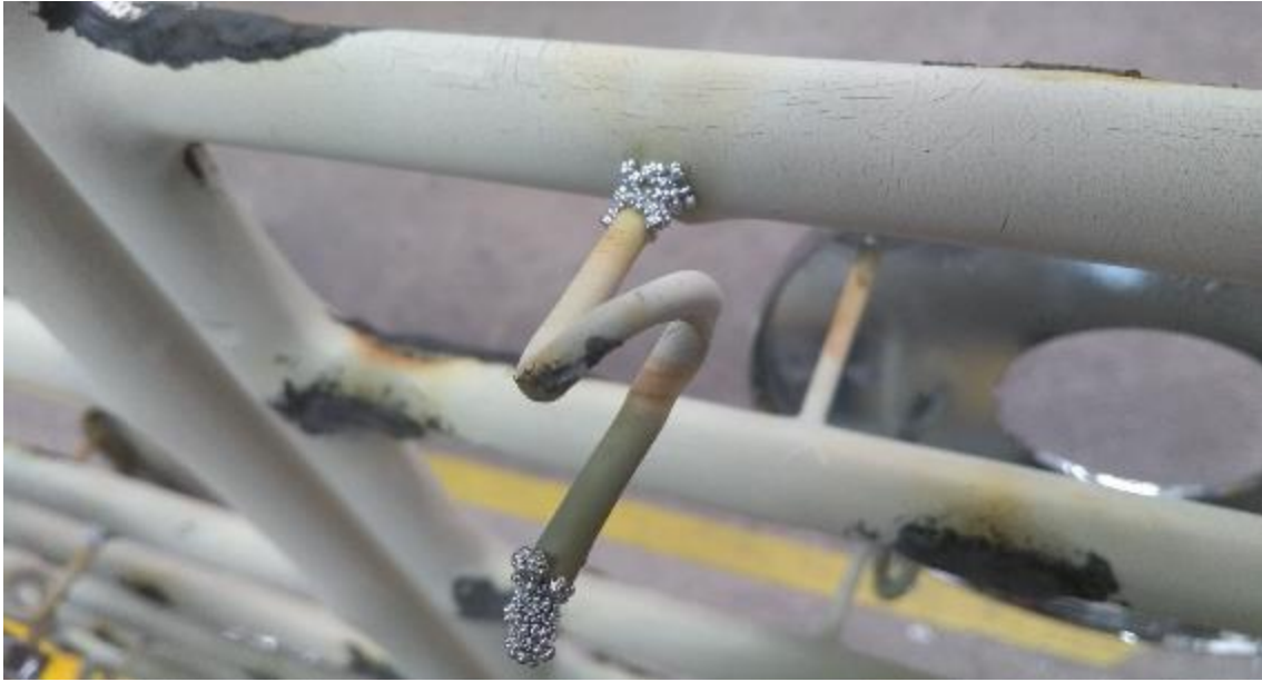
Figura 15 Poro en plastisol atacado por los químicos del proceso – coral.
