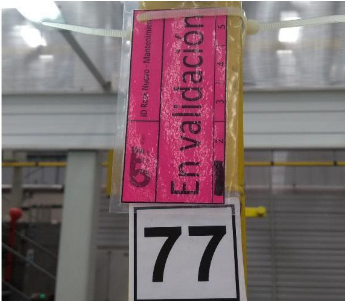
Figura 21 Formato “Identificación rack nuevo – mantenimiento” en barra con racks en validación con 1 ciclo.
