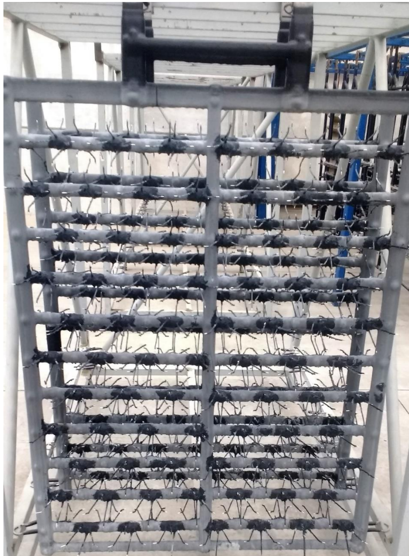
Figura 37 Rack 1054 con alto deterioro en el plastisol y los puntos de contacto / sujeción.
