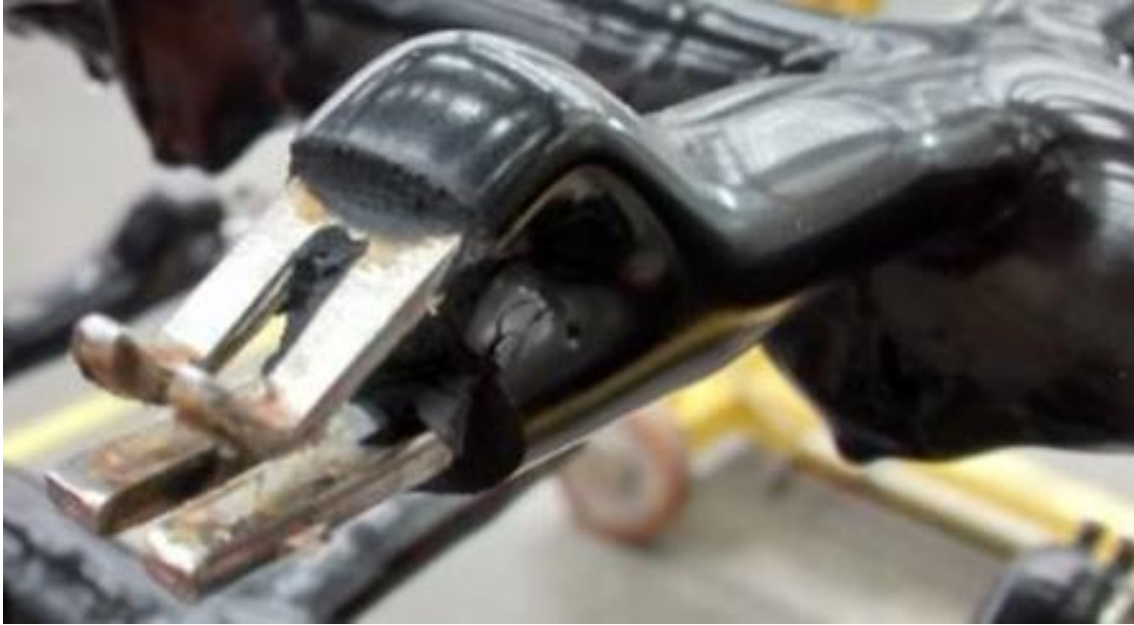
Figura 12 Contacto y punto de sujeción de acero inoxidable.
