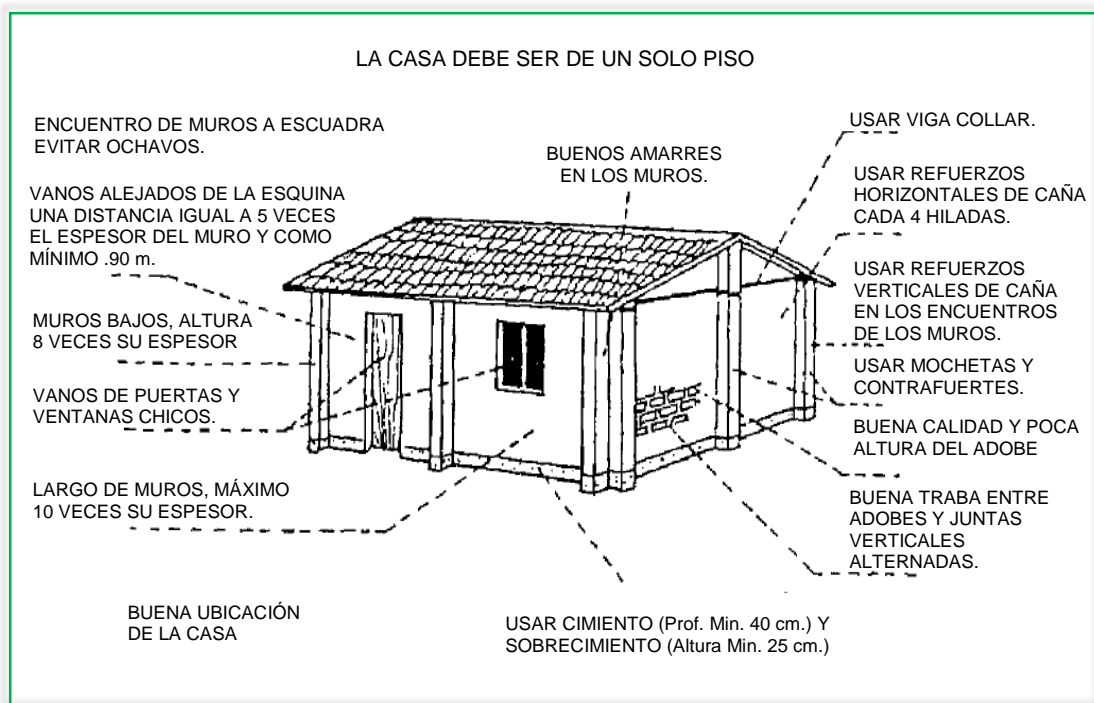
Figura 11. Muros de Adobe, recomendaciones básicas
