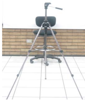
Colocación de un fondo libre de distracciones y un triple para mayor estabilidad, siempre a la misma distancia FIG. 2
