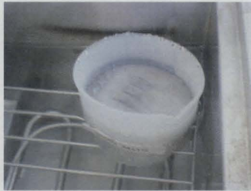
Figura 4.24. Obleas en solución \text{H}_2\text{O}:\text{HF} 7:1 en baño maría a 80^\circ\text{C} .
