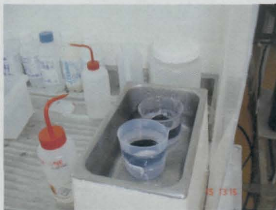
Figura 4.18. Etapa desengrasante en TCE y en Acetona en vibrador ultrasónico.
