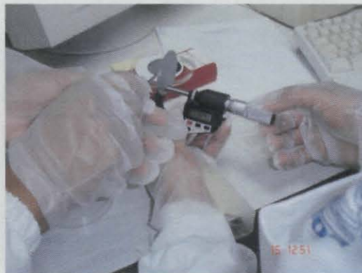
Figura 4.13. Verificación del espesor de la oblea con micrómetro.
