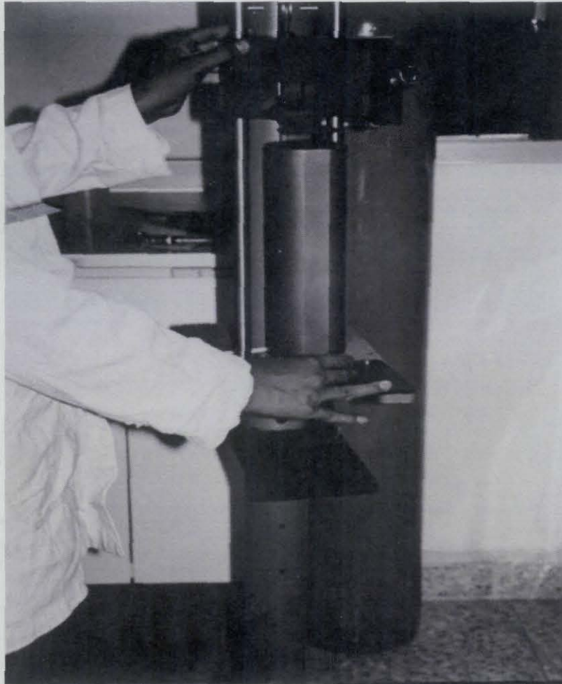
Figura 2.15. Medidor de resistividad del lingote de silicio ya rectificado, cortesía Planta piloto de crecimiento de silicio, Departamento de Microelectrónica ICUAP.
