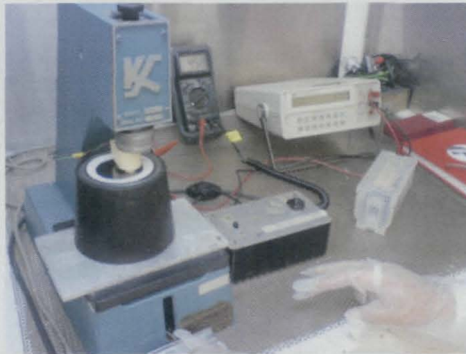
Figura 4.16. Medición de la resistividad con un medidor de 4 puntas.
