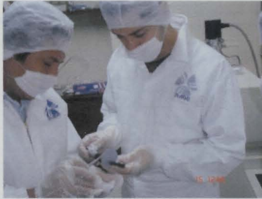
Figura 4.12. Verificación el espesor de las obleas de silicio con un micrómetro
