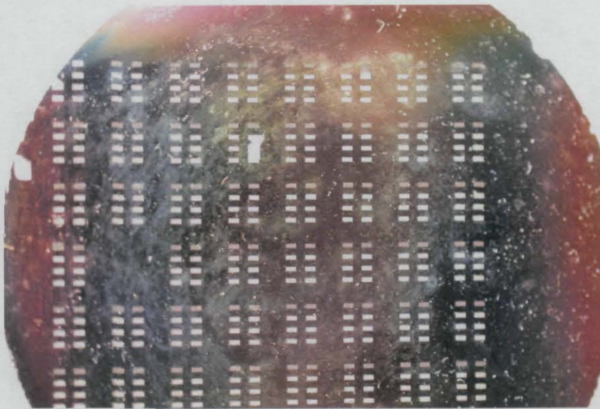
Figura 6.14, Oblea de silicio de 5 cm de diámetro con 8x6 BioMEMS, vista superficie pulida de la oblea.
