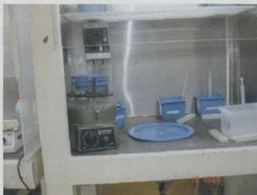
Figura 4.20. Sistema Súper Q, para limpieza profunda de las obleas.
