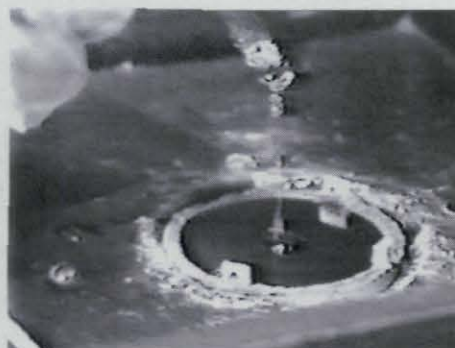
Figura 3. 14, Máquina centrífuga para el depósito de la resina fotosensible. Esta máquina trabaja de 500 a 3000 rpm, la oblea de silicio se sujeta por vacío. (Departamento de Semiconductores BUAP).
