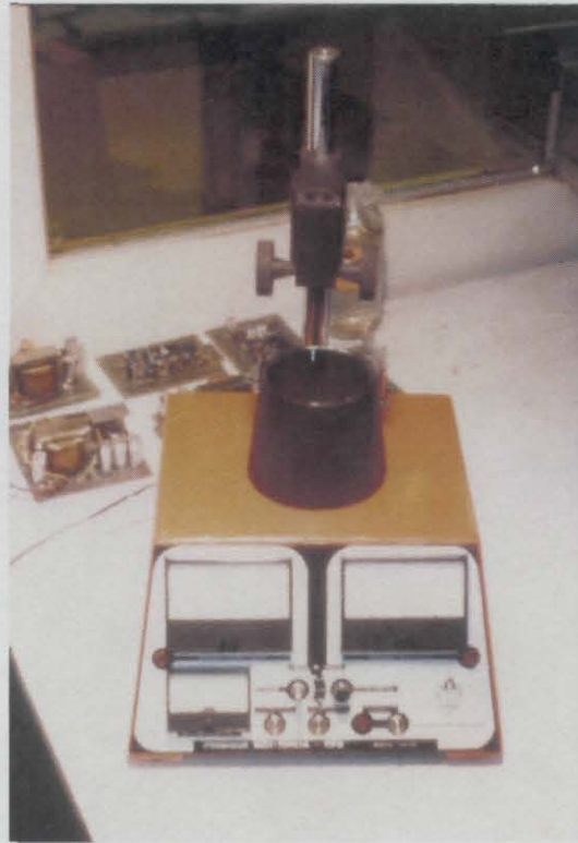
Figura 3. 24, Máquina 4 puntas para medir resistencia de hoja que incluye un medidor de punta caliente para determinar el tipo de conductividad del material, Tipo P o Tipo N.
