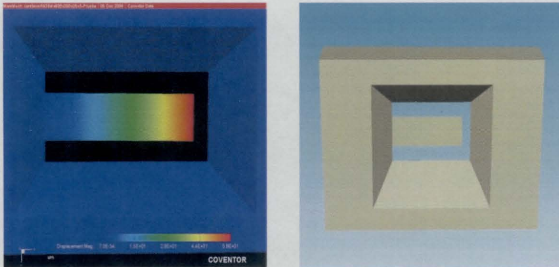
Figura 7.21 , Vista normal de la simulación de esfuerzos en un cantiléver utilizando COMSOL, (a) la región roja está sometida a mayor tensión, (b) dibujo del cantiléver en la alberca.
