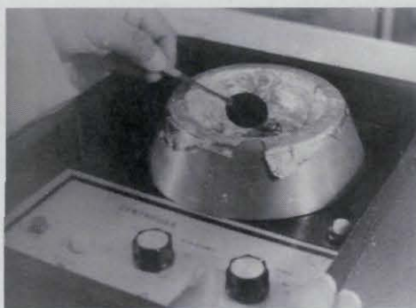
Figura 3. 14, Máquina centrífuga para el depósito de la resina fotosensible. Esta máquina trabaja de 500 a 3000 rpm, la oblea de silicio se sujeta por vacío. (Departamento de Semiconductores BUAP).
