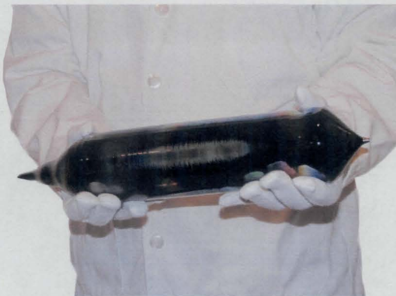
Figura 2.13. Lingote de silicio (Departamento de Microelectrónica, BUAP).
