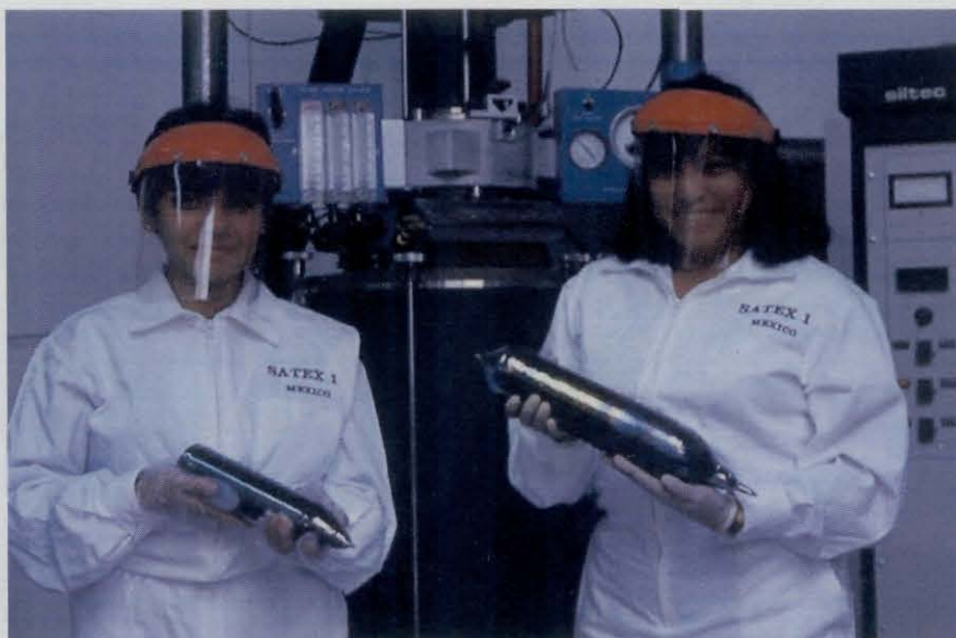
Figura 2.12. Lingotes de Silicio crecidos en el Departamento de Microelectrónica, BUAP.
