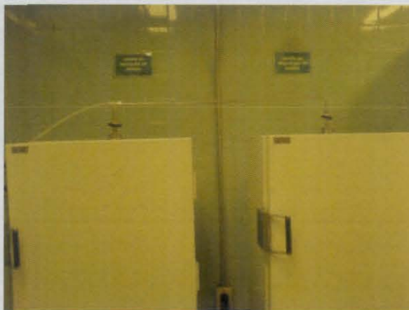
Figura 4.23. Hornos de cocido y pre-cocido de resina.
