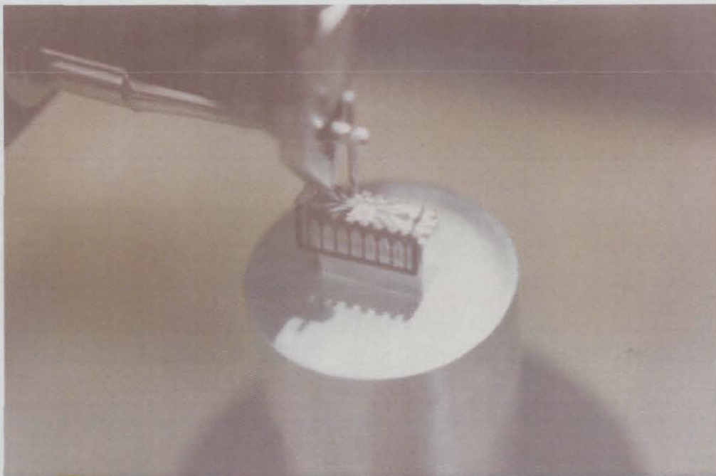
Figura 3.35, Detalle de un microsoldado de un circuito integrado, Departamento de Semiconductores UAP.
