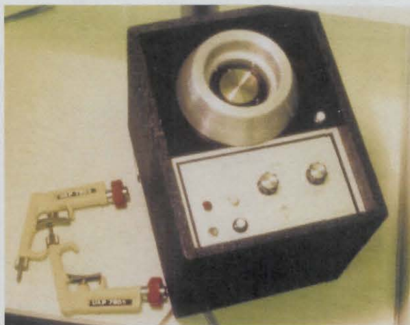
Figura 3.13. Máquina centrífuga para el depósito de resina fotosensible y pistolas para secado con nitrógeno.
