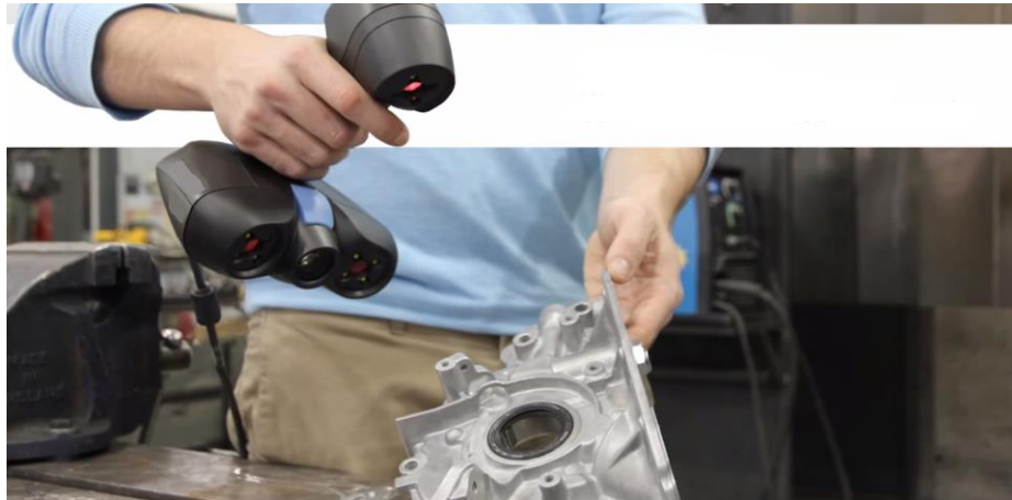
Figura 3.3 Ilustración de escaneo de NO contacto.
