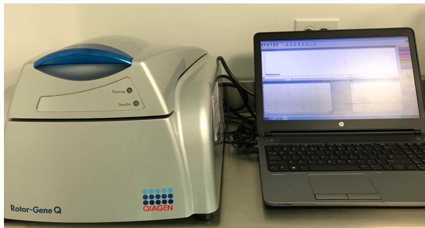
Figura 7. Termociclador Rotor Gene Q® de Qiagen (sistema óptico de dos canales de detección: verde 510 \pm 5 nm y amarillo 557 \pm 5 nm).
