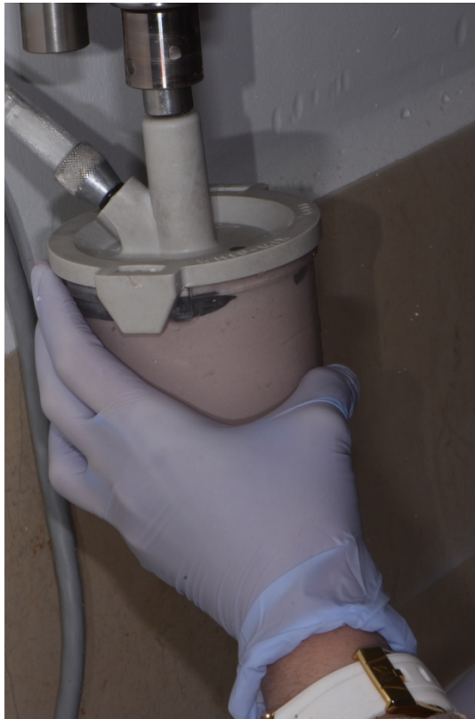
Figura 150. Mezclado al vacio de revestimiento
