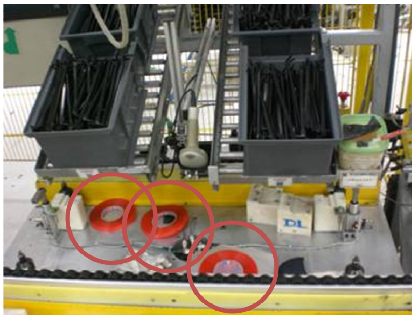
Figura 3.3. En la estación 40 tienen más cinta doble cara de la que se necesita en dos turnos.
