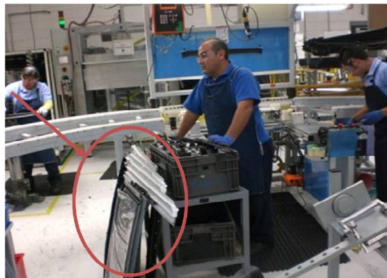
Figura 3.6 Dos sub-ensambles son colocados en el suelo esperando la próxima operación.
