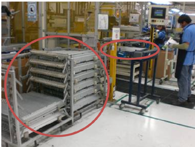
Figura 3.4. El operador traspalea los rieles del rack a la máquina.
