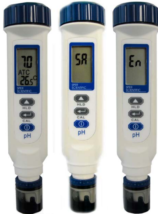
Imagen 3. Microprocesador pHmetro large display pH Pen 850051 marca Sper Scientific, previamente calibrado (pH 7).
