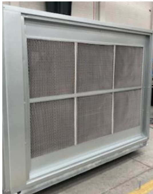
Figura 15. Equipo lavador de aire cliente SP
