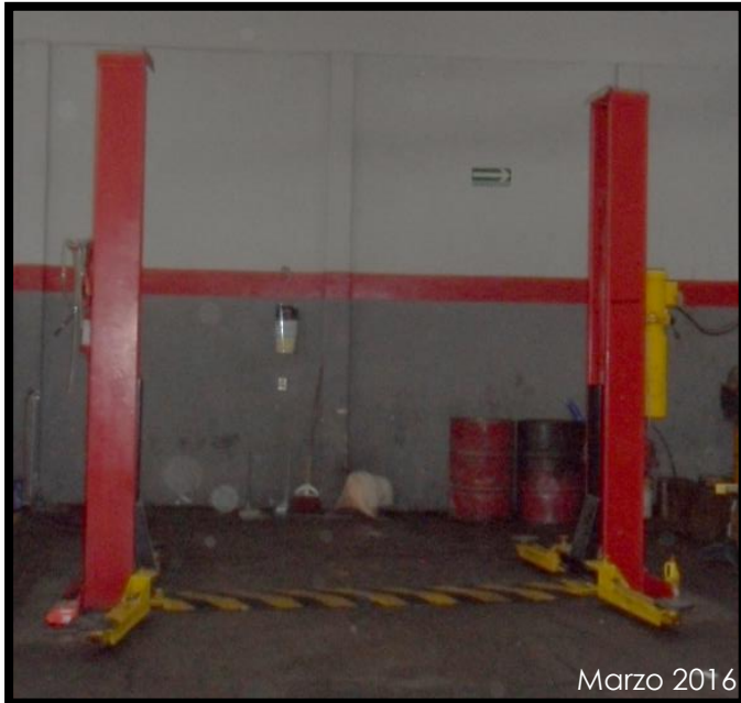
Elevador hidráulico de 4 brazos laterales, con la capacidad de levantar hasta 4 toneladas, para el área de suspensiones.
