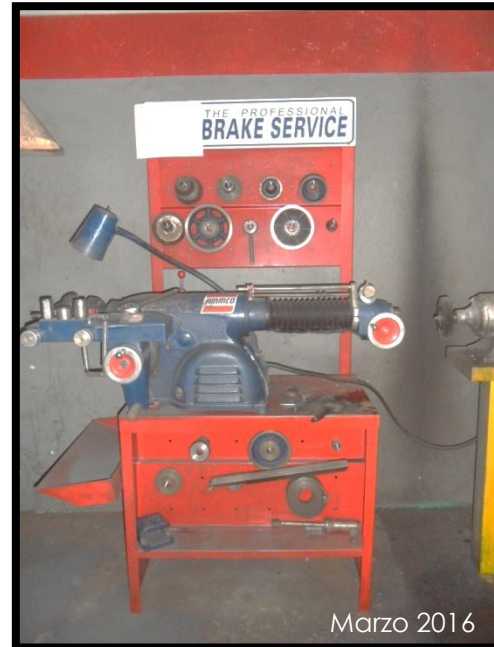
Torno para la rectificación de discos de freno para el área de mecánica.
