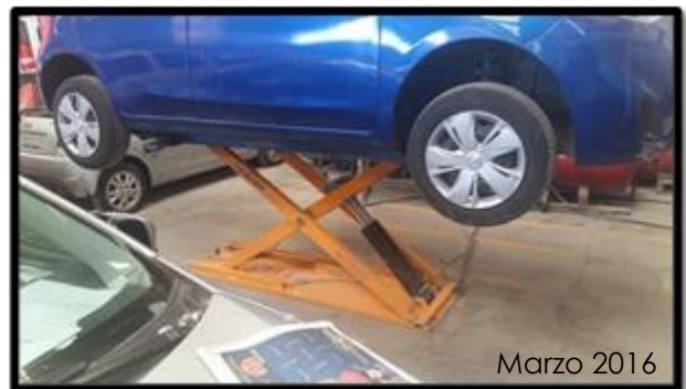
Elevador hidráulico para sacar golpes y abolladuras.
