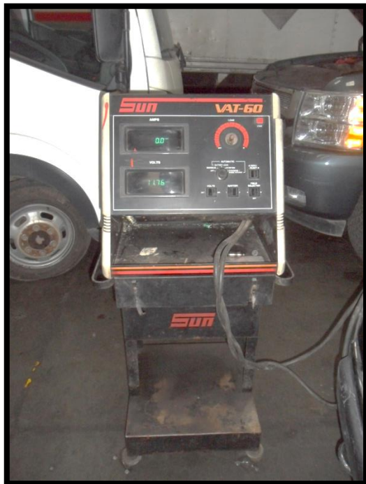
Medidor general de baterías industrial, para el área de electricidad.
