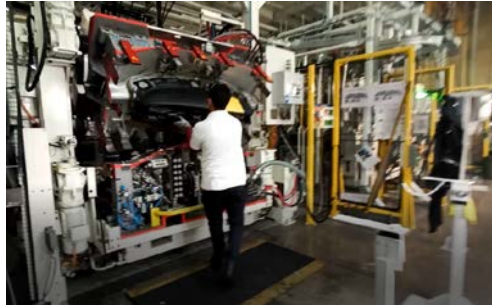
Ilustración 15 Montaje de tablero
