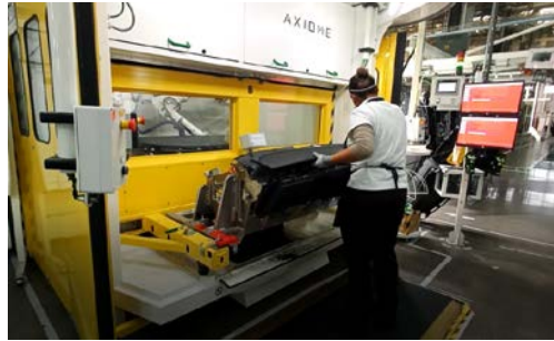
Ilustración 19 Instalación de tablero en milling
