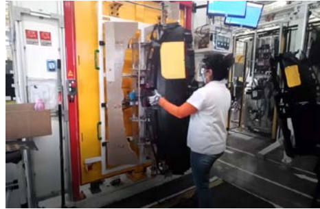
Ilustración 12 Instalación de tablero
