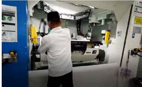
Ilustración 23 Extracción del tablero troquelado
