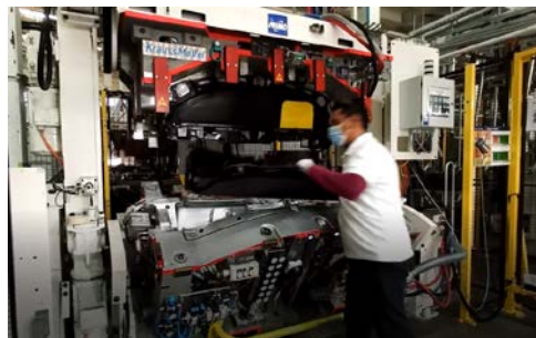
Ilustración 18 Extracción de tablero
