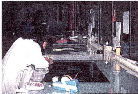
Es retocado manualmente con una tinta que bloquea el paso de la luz
