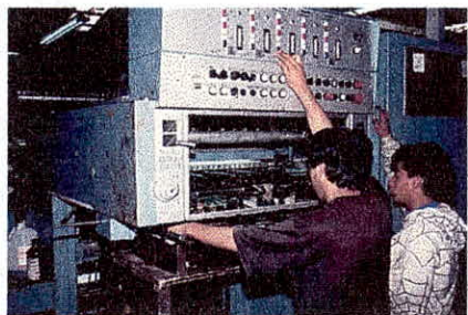
El suministro de tinta, los registros y la velocidad son contralados electrónicamente
