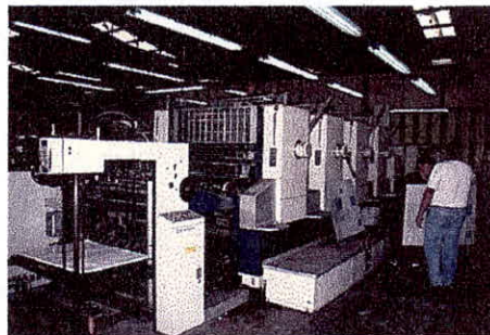
En el primer plano podemos observar la alimentadora de papel
