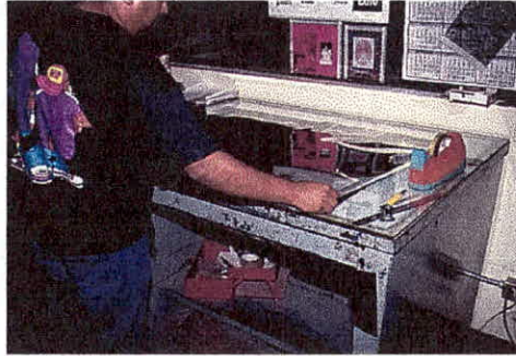
La unión de negativos se realiza con cinta roja transparente
