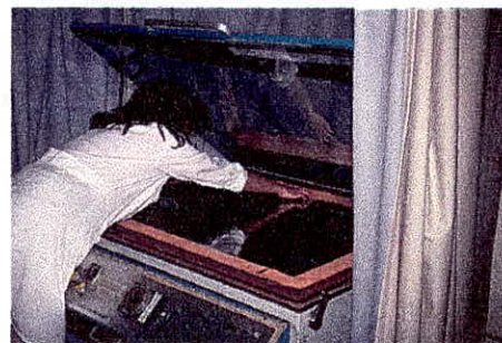
El negativo es colocado encima de la lámina tomando en cuenta el registro de la base
