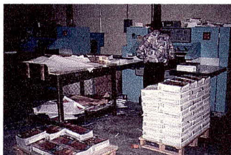
Al terminar de engrapar una revista se requiere refinar trilateralmente
