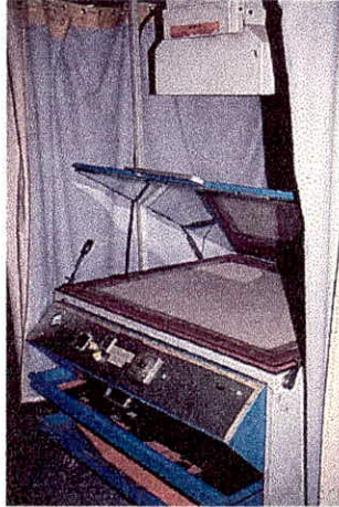
La lámina de Aluminio se coloca sobre la mesa de exposición en luz de arco
