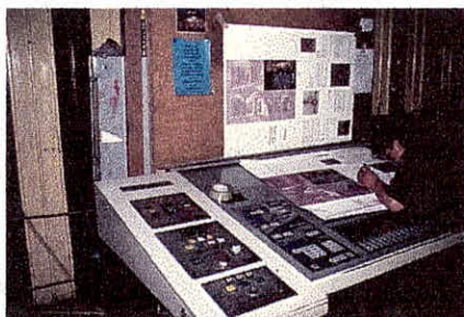
Dentro de la maquinaria se encuentra el horno de secado para evitar un repegado del papel
