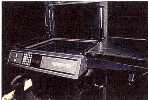
El original es colocado en la cámara fotomecánica al vacío
