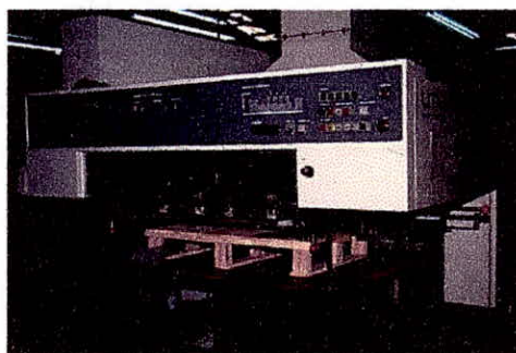
Al final de la máquina se encuentra el panel de seguridad y la receptora de papel
