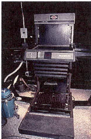
La cámara fotomecánica ocupa un espacio pequeño y se coloca dentro de un cuarto oscuro
