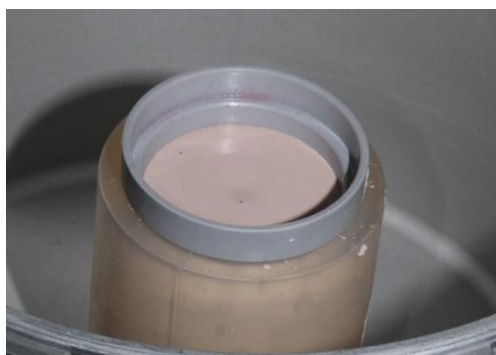
Foto 32.- El cilindro se coloca en el centro de la olla de presión.
