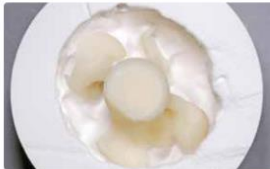
Foto 36.- Con oxido de aluminio se elimina el revestimiento
