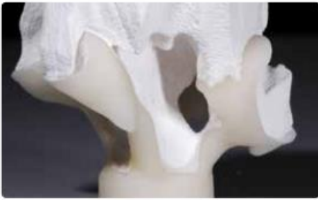
Foto 37.- Se elimina con cuidado el resto de revestimiento
