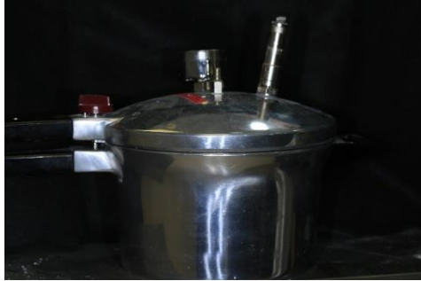
Foto 33.- Se coloca en la olla de presión a 2 bares
