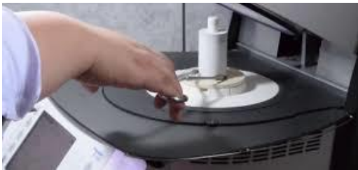
Foto 34.- Se coloca en la olla de presión a 2 baresintroduce al horno de inyección, y se elige el programa según sea el caso
