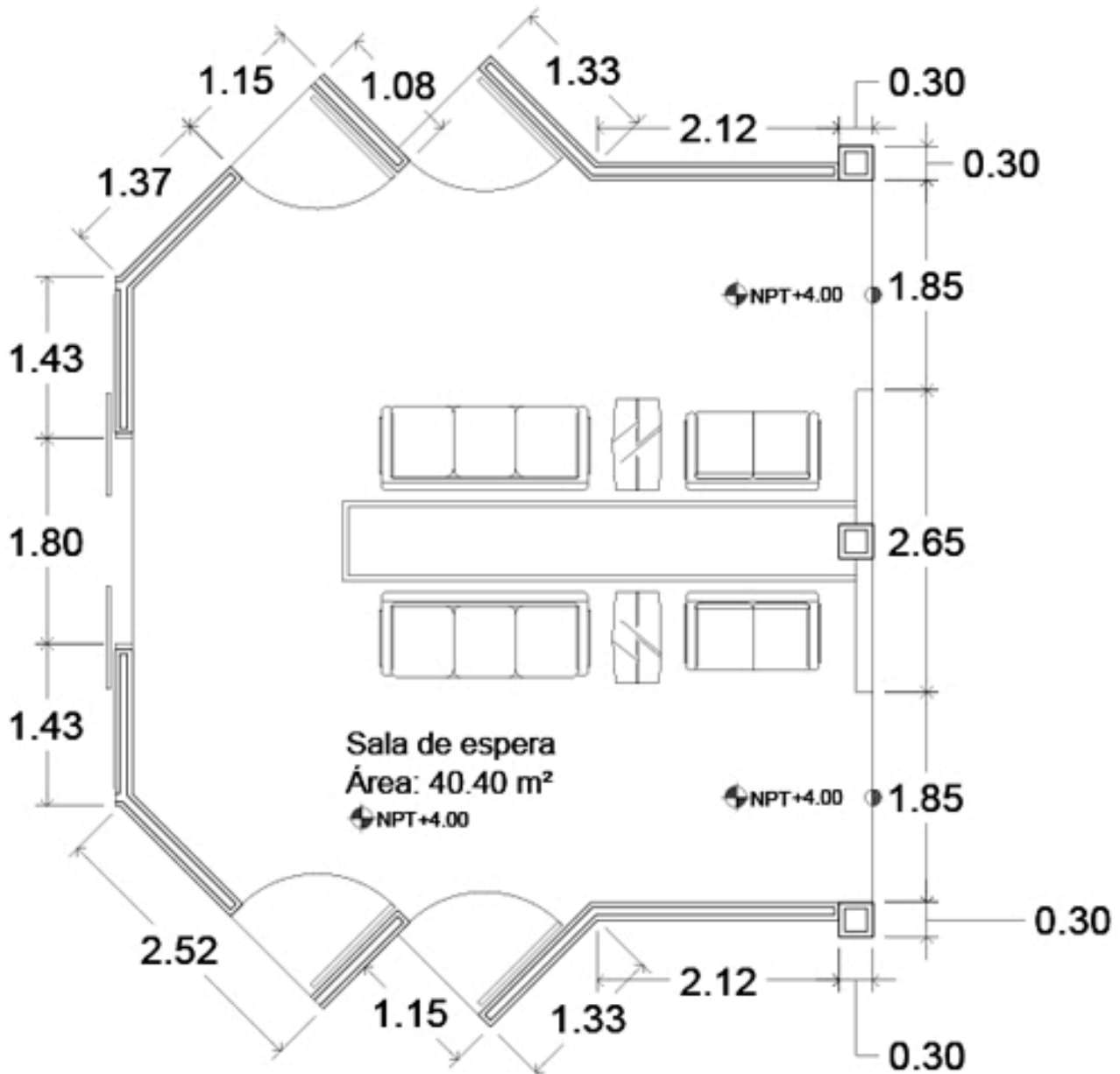
Plano 05. Planta arquitectónica sala de espera administración.
