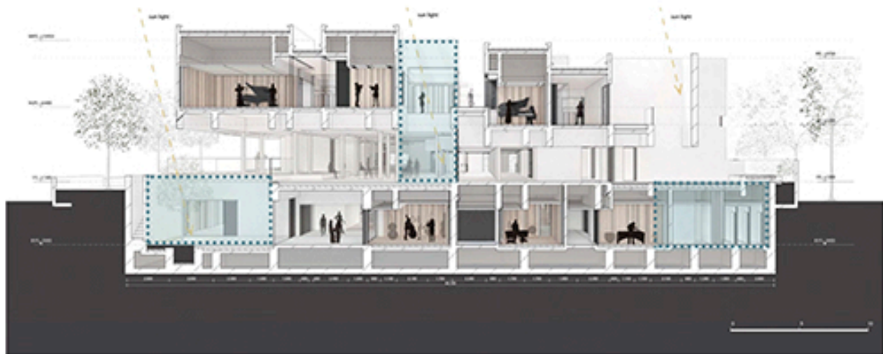
Imagen 37. Corte arquitectónico transversal Norte-Sur.
