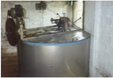
Extractor eléctrico con capacidad para 72 bastidores.
