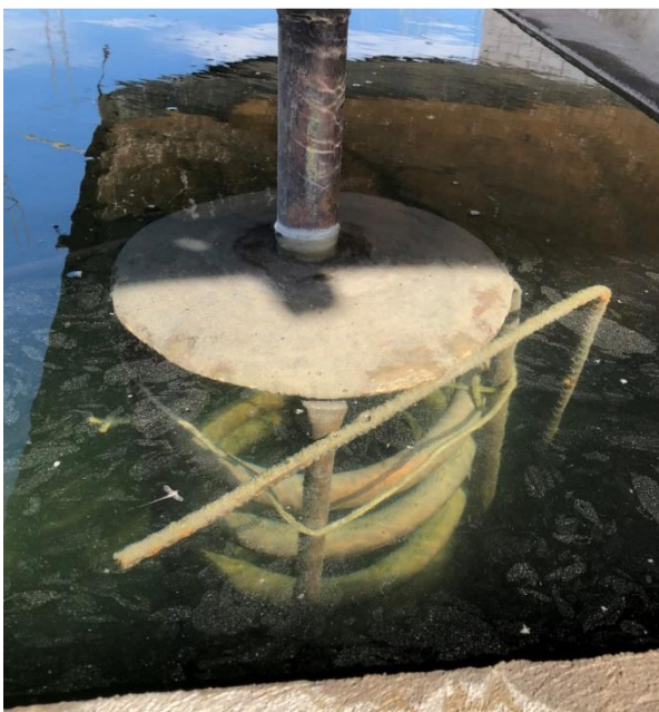
Figura 42. Alambique - Serpentín de enfriamiento para condensación
