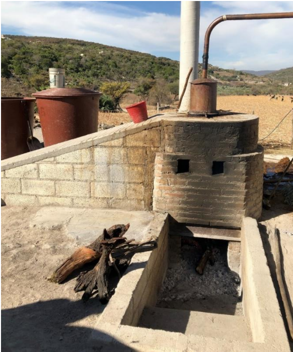
Figura 41. Alambique- caldera de cobre con fuego directo
