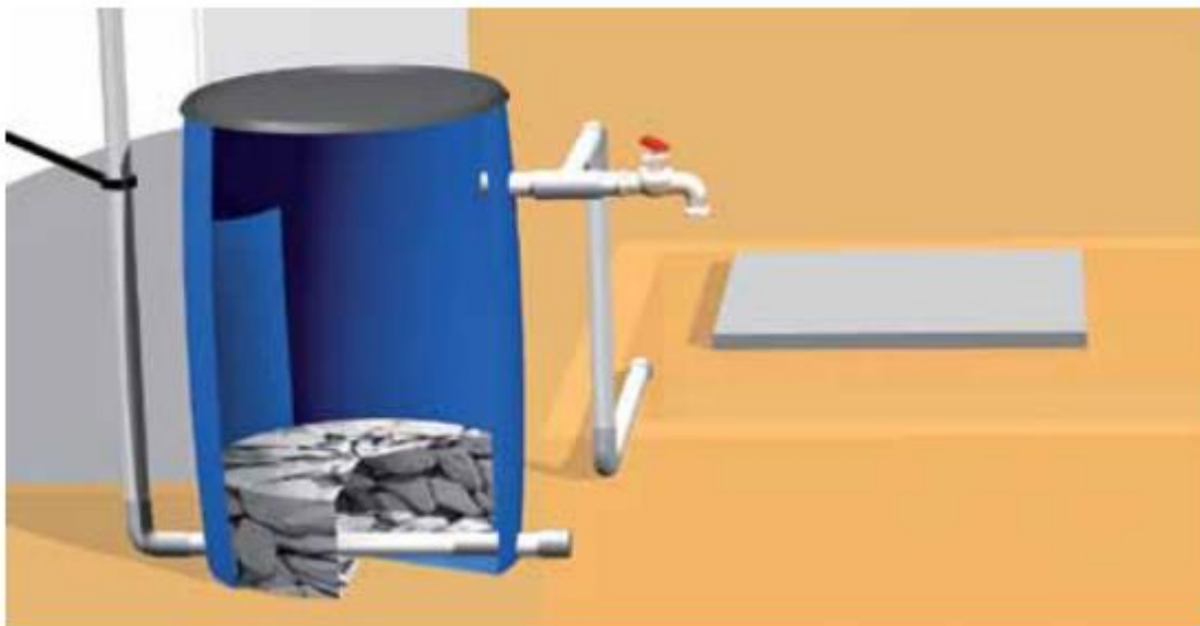
Figura 104. Disposición de la grava y el tramo de PVC en el bote (SEMARNAT et al., 2010)
