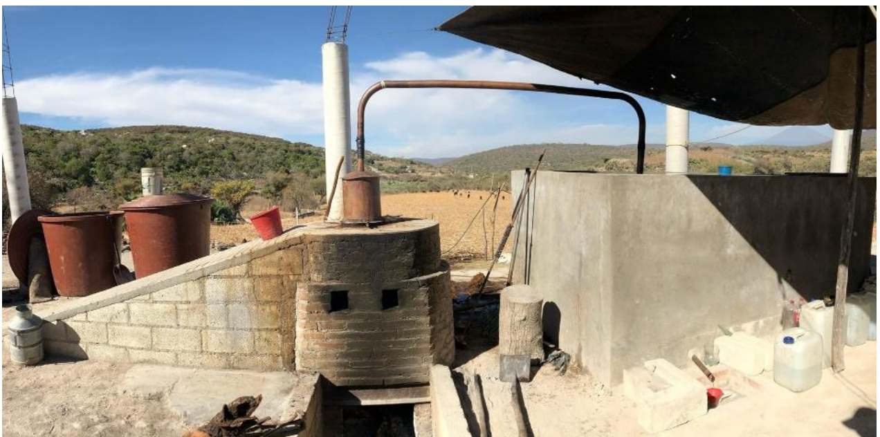
Figura 40. Alambique para destilación artesanal
