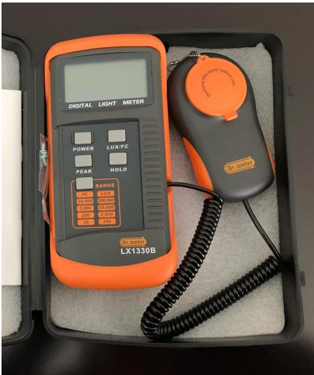
Figura 18. Luxómetro Dr. Meter LX1330B
