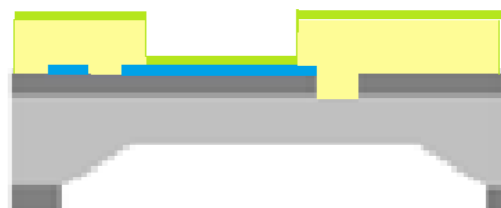
Fig. 4.14 0.5 \mu\text{m} de Al es evaporado en la parte superior del fotoresistor.
