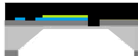
Fig. 4.17 La oblea se cubre con cera negra, es grabada al 20% en KOH a 48 °C (la cera se disuelve alrededor de los 60 °C). La oblea es grabada hasta tener aproximadamente 15 \mu\text{m} de silicio.
