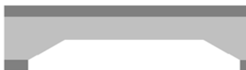
La Fig. 4.9 las obleas son sumergidas en una solución de KOH al 30%. Se graba anisotrópicamente la capa de sacrificio de Si con KOH sin dañarlo, solamente el 60% de la oblea es grabado para facilitar todo el proceso.
