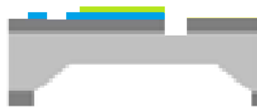
Fig. 4.15 La oblea es entonces bañada con acetona y las áreas no deseadas de fotoresistencia y Al son retiradas. Las capa de Al actúa como un electrodo superior para el piezo-cantilever
