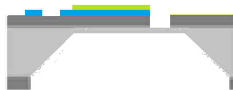
Fig. 4.18 La cera es removida mediante un baño en tolueno.
