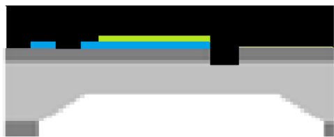
Fig. 4.16 Una capa gruesa de cera negra es aplicada al frente de la oblea. La cera negra es resistente al KOH y protegerá a las capas del metal y ZnO desde que esta siendo atacado por el KOH.
