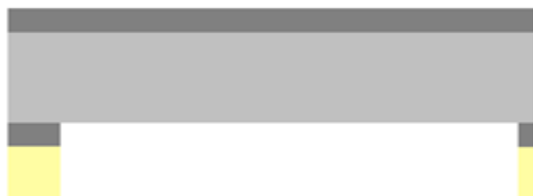
Fig. 4.7 nos muestra el grabado de KOH y tiene como objetivo eliminar las áreas expuestas de Si.
