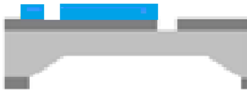
Fig. 4.12 El ZnO es fotolitografiado y las áreas no deseadas son grabadas en ácido débil
