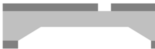
Fig. 4.10 El lado frontal de la oblea fue fotolitografiada. El patrón del lado frontal define la estructura del cantilever.
