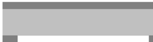
Fig. 4.8 indica como la fotoresistencia se elimina después de haber usado acetona y metanol.
