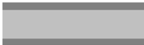
Fig. 4.4 nos muestra un depósito de 15 \mu\text{m} de espesor en ambos lados de una capa de Si.
