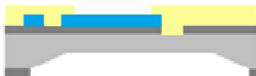
Fig. 4.13 El frente de la oblea es cubierto con fotoresina, este paso es para preparar el retiro del Al.
