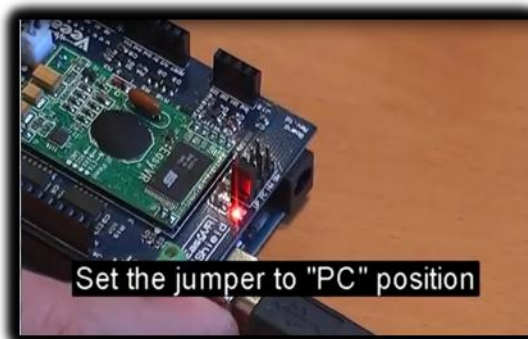
Figura 3: 84 Colocando el jumper en la posición PC
