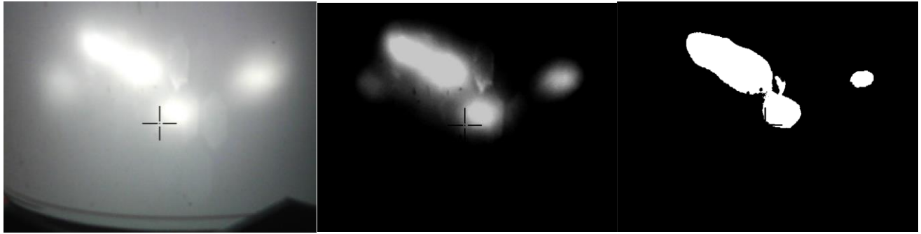
Fig. 5.11. Aplicación de filtrado para eliminar ruido de la imagen y obtener una imagen binaria en la imagen obtenida de la cámara de espectro visible.
