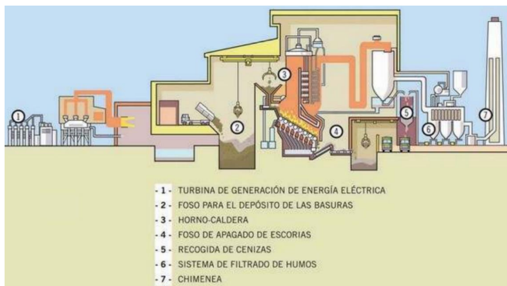
Fig. 2.5. Esquema general de una planta incineradora Gloriselle Negrón Ríos, MS, JD Catedrática Asociada en Salud Ambiental Programa de Agricultura, Mercadeo y Recursos Naturales diciembre 2012
