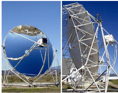
Fig. 3.2. Colector solar diseñado para impulsar un motor Stirling.
