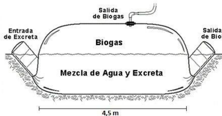
Fig. 2.11. Diagrama de un biorreactor conocido como biodigestor, donde se busca la obtención de Metano.
