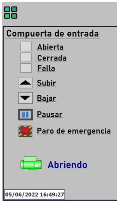
Ilustración 31 Estado de la compuerta, desarenador Talconapan.
