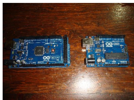
Fig. 95 Comparación de ARDUINO MEGA 2560 vs ARDUINO UNO.
