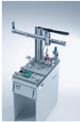
FIG. 27 CUARTO MPS ESTACIÓN DE MANIPULACIÓN.
