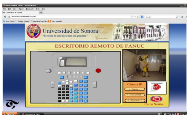
FIG. 35 PÁGINA PARA CONTROL REMOTO ROBOT FANUC.
