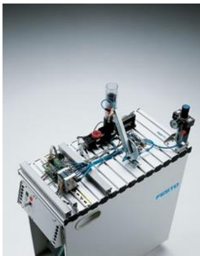
FIG. 24 PRIMER MPS ESTACIÓN DE DISTRIBUCIÓN.
