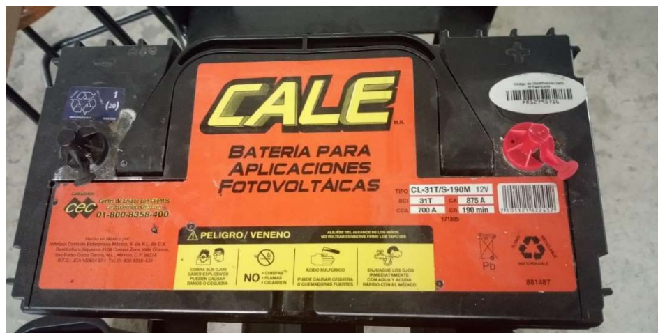
Figura 30. Parte superior de batería indicando valores de operación en el lado derecho.
