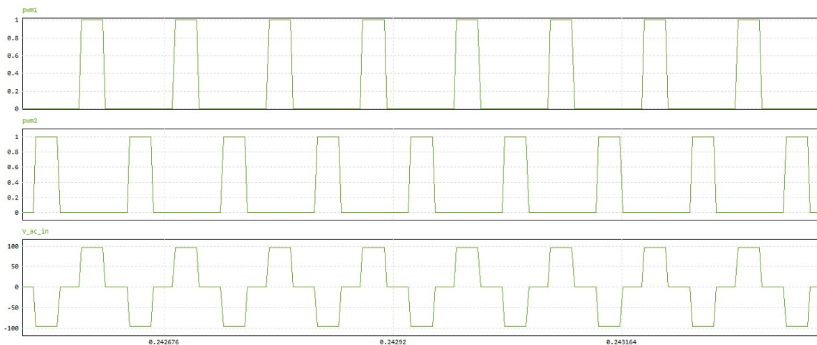
Figura 32. Gráficas mostrando los 2 PWM de entrada y el voltaje resultante respectivamente.
