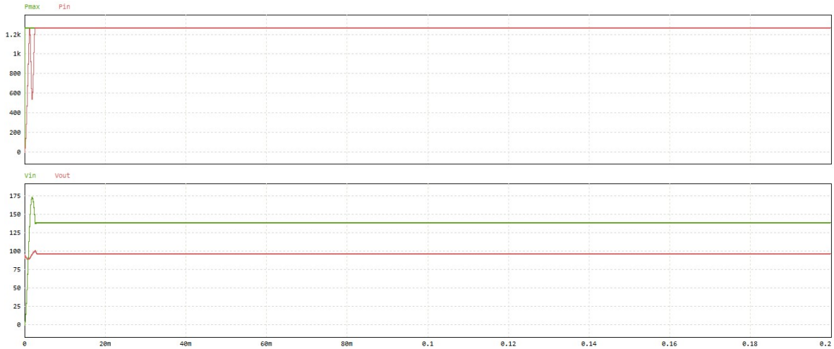
Figura 25. Gráficas comparativas entre potencias y voltajes respectivamente ante un voltaje constante.
