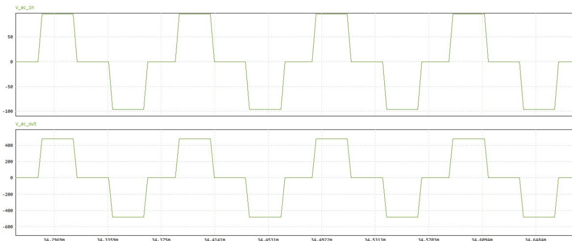
Figura 33. Gráficas comparando voltaje de entrada al transformador con el de salida respectivamente.
