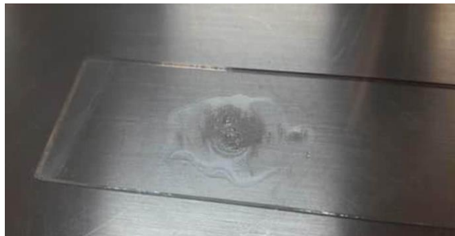
Imagen 5. Prueba de la catalasa positiva con peróxido de hidrógeno al 30%.
