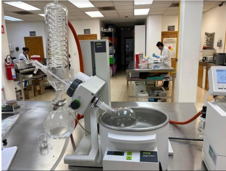
Figura 3.3 Equipo de rotavapor concentrando los extractos de Ganoderma lucidum chino y nacional en diclorometano y metanol.
