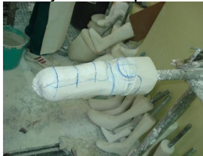
Figura 57. Muñón de yeso con las protuberancias definidas
