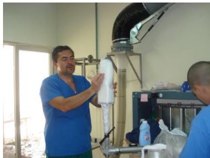
Figura 58. Eliminación de relieves defectuosos
