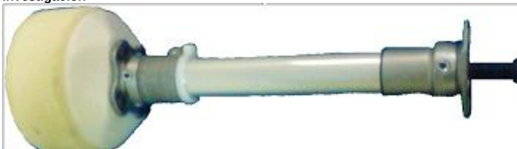
Figura 46. Sistema piramidal de alineación maquinado en México durante esta investigación
