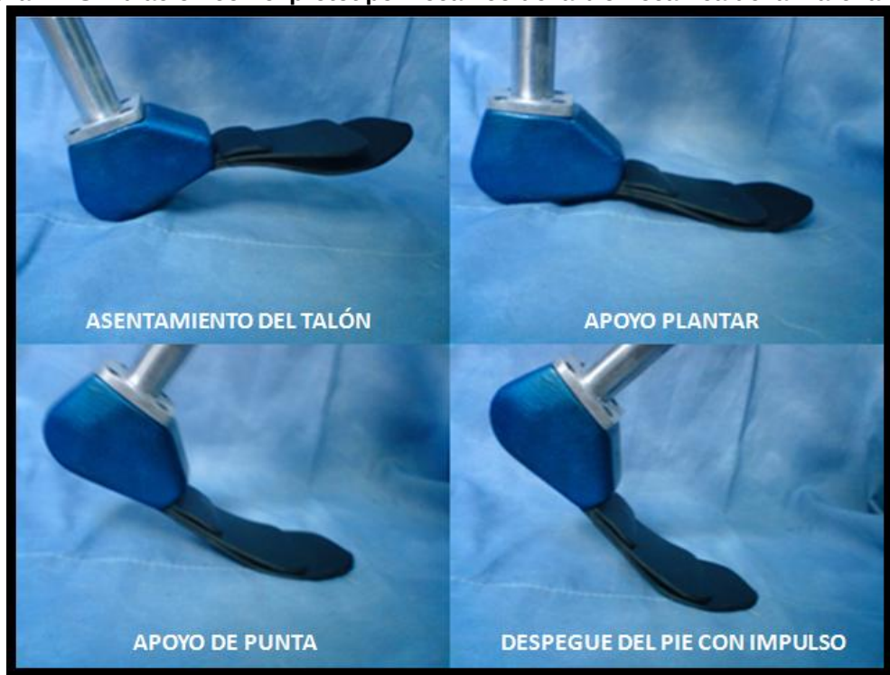
Figura 44. Simulación con el prototipo mecánico de la biomecánica de la marcha
