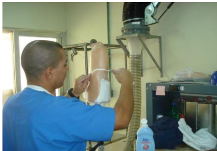
Figura 60. Laminación del socket con resina poliéster
