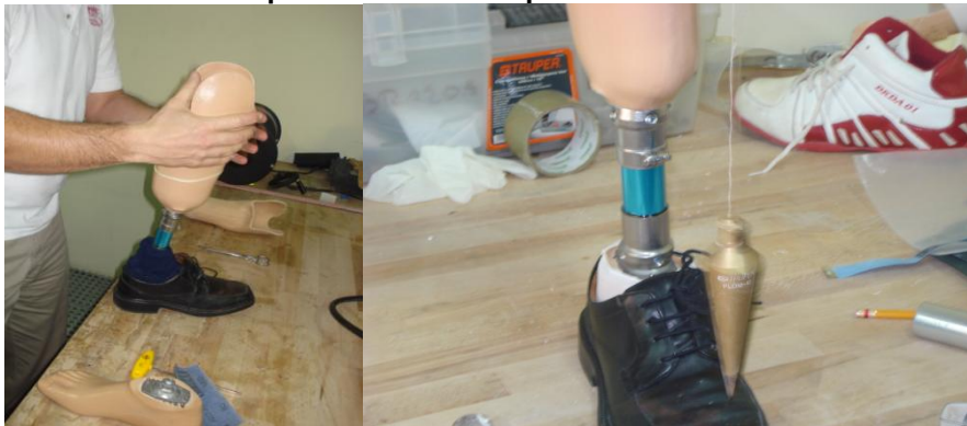
Figura 73. Alineación de la prótesis mediante péndulos
