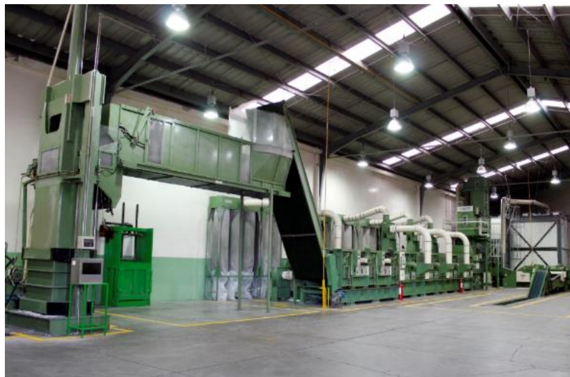
Imagen 4: Máquina transformadora de desechos textiles de todo tipo, en fibras para fabricación de hilo “Deshilachadora”, (Poin, 2018b).
