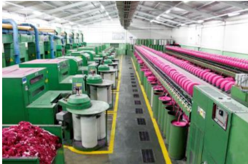
Imagen 3: Máquinas transformadoras de materia prima en hilo “Cerdas y Open-End”, (Poin, 2018a).
