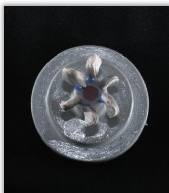
Fig.103. Colocación de los dados refractarios (vista superior)
