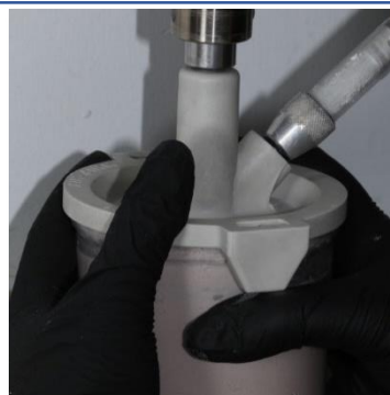
Fig. 178. Mezcla de revestimiento en mezcladora al vacío
