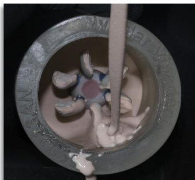
Fig. 179. Proceso de revestimiento
