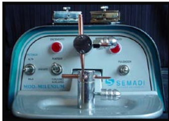
Fig.11. A) Se utilizó una punteadora (semadi). En casos de rotaciones severas para puntear el bracket a la banda y evitar que este se desprenda al activar los resortes
