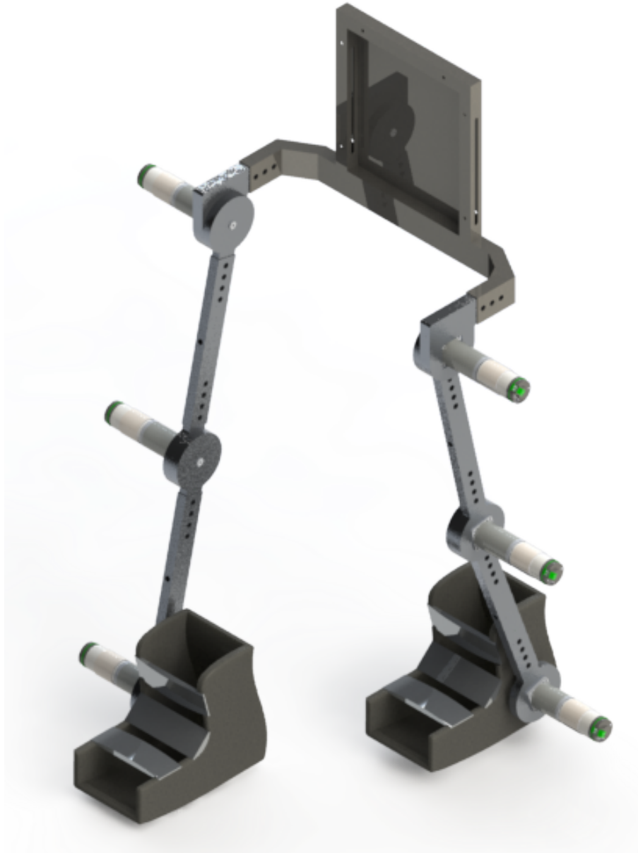
Figura 5.7: Diseño de la estructura mecánica del exoesqueleto
