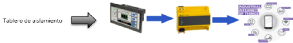
Figura 45. Monitor en tiempo real de equipo, con la implementación del módulo de monitoreo con 4GIP (Bender).
