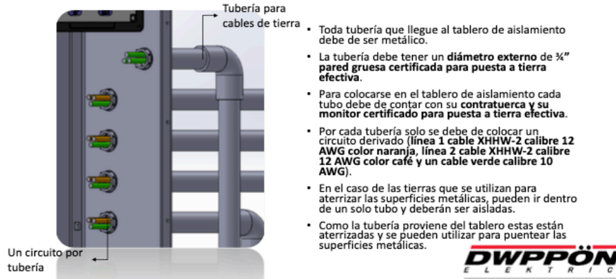
Figura 17. Canalización de circuitos derivados. Fuente: Dwppon Elektríc línea médica.
