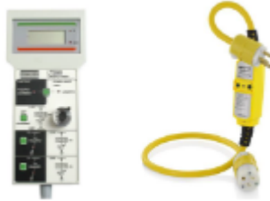
Figura 23. Equipo para efectuar prueba de GFCI.
