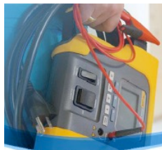
Figura 39. Para esta prueba se recomienda un multímetro que sea de alta precisión y una resolución de \mu A . Mod. ESA609.
