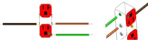
Figura 29. La polaridad de las conexiones en los contactos, tengan la misma secuencia.
