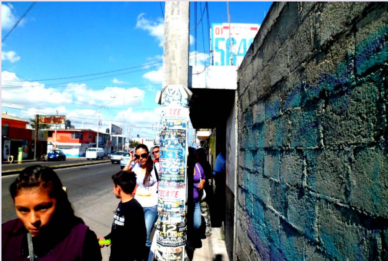
Imágenes de la 3.48 a la 3.51 Arriba izquierda peatón incorporándose a la 16 de septiembre se observa que no existe un paso adecuado. Arriba derecha peatones cruzando la 16 de septiembre en medio de la calle. Izquierda abajo se observa como los peatones tienen que bajar de la banqueta pues los obstáculos como el poste no permiten el uso correcto además de que el ancho de la banqueta es insuficiente, derecha abajo peatones cruzando la 16 de septiembre nótese que no existe señalética horizontal.
