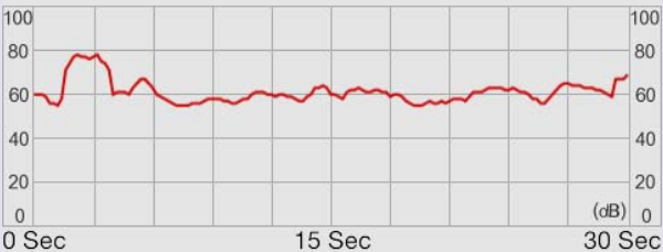
3.88 Imagen .-Muestra de niveles de decibeles captados dentro de la Unidad Habitacional San Bartolo a las 17:40 hrs.
