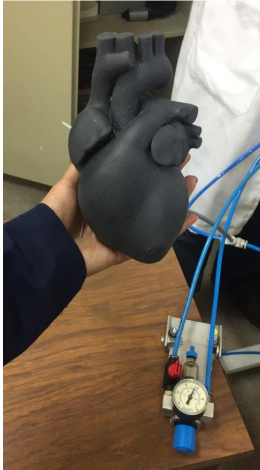
Figura 5.3: Corazón impreso en 3D con Resina conectado a una electroválvula
