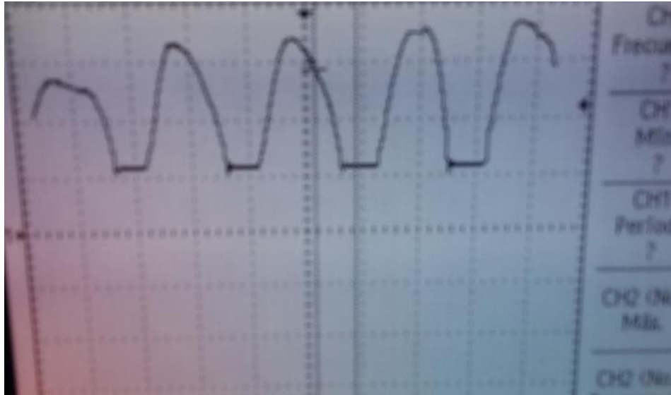
Figura 5.5: Salida del osciloscopio que muestra un Capnograma, es decir tiempos de inspiración y espiración así como amplitud de la señal respiratoria.
