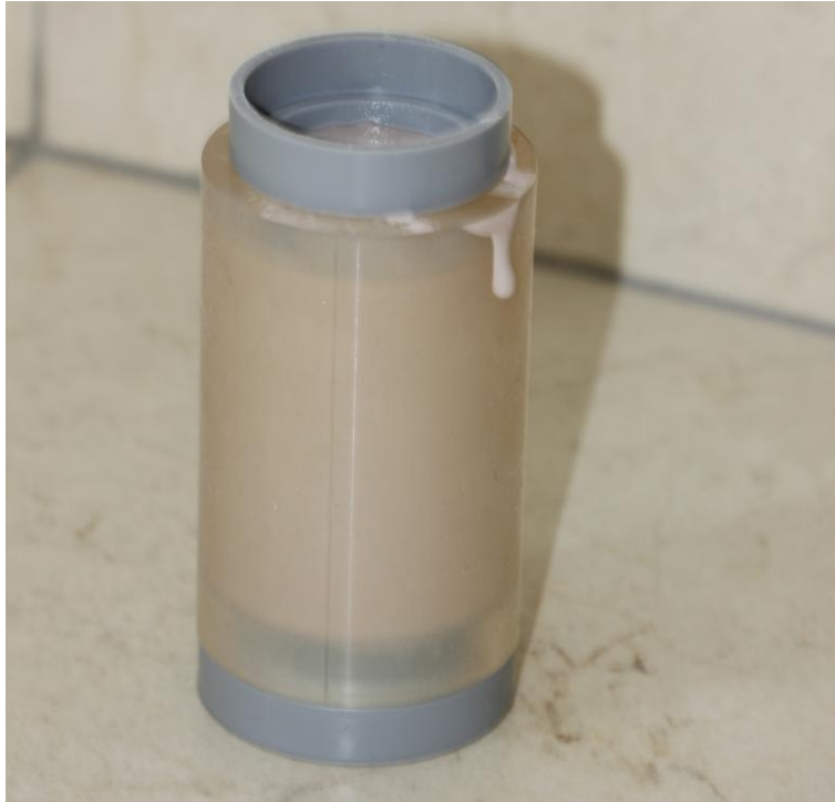
(Fig. 26) Cilindro de revestimiento en proceso de fraguado
