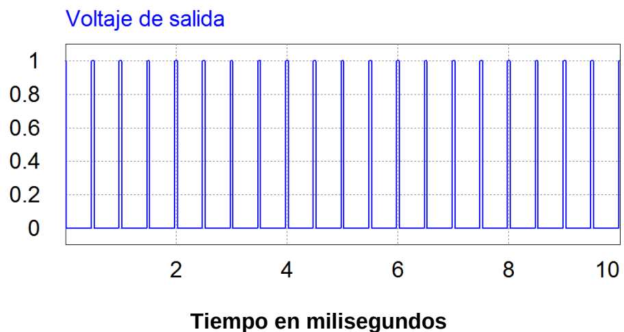
Figura 21 Voltaje de salida con el 10% en alto
