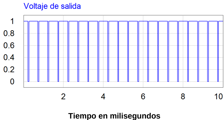
Figura 20 Voltaje de salida con el 90% en alto
