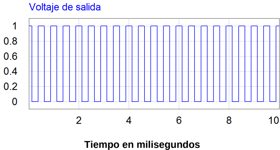
Figura 22 Voltaje de salida con el 50%
