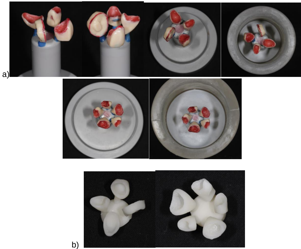
Figura 172. a) Procesado de las restauraciones de cera para el inyectado de la porcelana b) Restauraciones inyectadas en disilicato de litio
