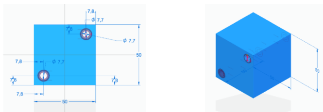
Figura 1. Cubo “A”- Dimensiones Alto: 50 mm Ancho: 50 mm Profundo: 50 mm.
