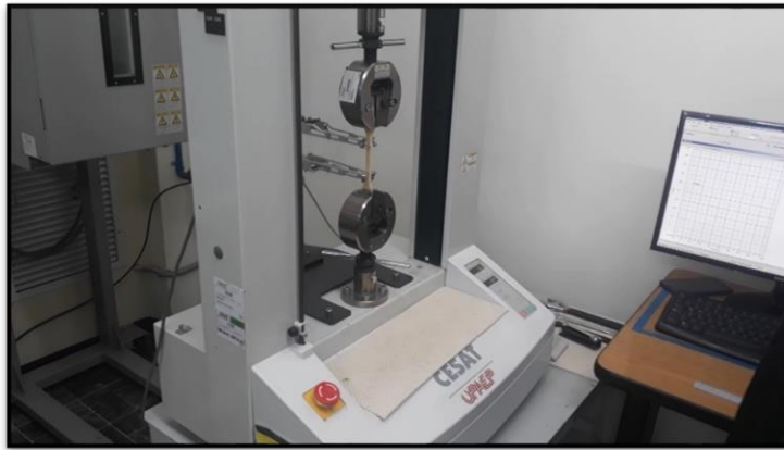
Figura 5. 18. Prueba de tensión a probeta manufacturada por moldeo de compresión.
