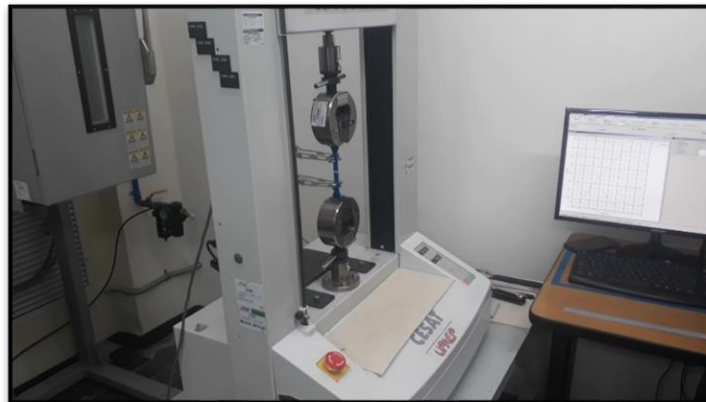
Figura 5. 17. Prueba de tensión a probeta impresa en 3D.
