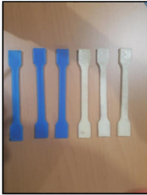
Figura 5.16. Probetas manufacturadas, de color azul, por Impresión 3D y de color blanco, por moldeo de compresión.
