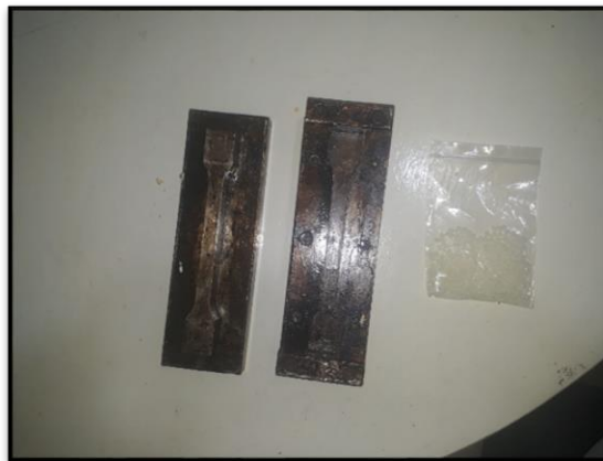
Figura 5. 13. Molde utilizado con el mismo diseño que el de impresión 3D y plástico granulado.
