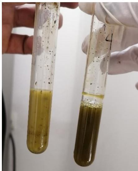
Figura 10. Formación de espuma en la prueba de Saponinas de uno de los extractos vegetales evaluados.
