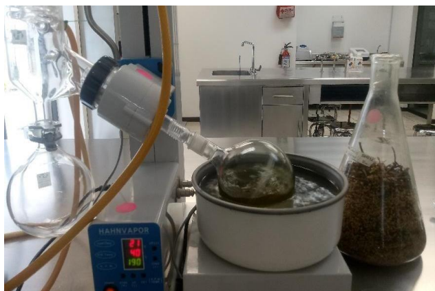
Figura 8. Proceso de extracción con el rotavapor marca Buchi. Laboratorio de Biotecnología Ambiental UPAEP.
