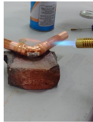
Figura 48. Soldado de piezas de tubería
