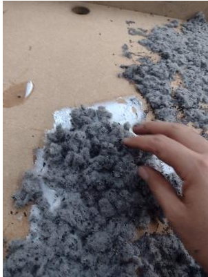
Figura 43. Fibra de caucho adherida en las paredes de la caja de madera
