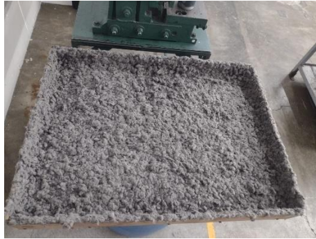
Figura 44. Terminación de fibra de caucho en la caja de madera
