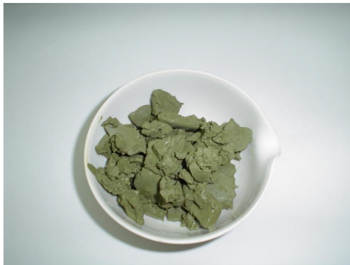
Fig. 3.9 Sólido residual recuperado durante la filtración en la cápsula de porcelana, para su calcinación
