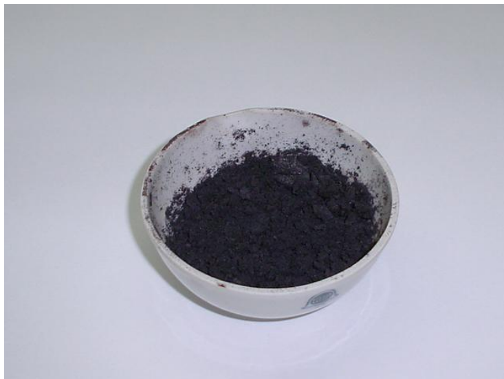
Fig. 3.11 Sólido residual, calcinado a 800°C / 2-2.5 hrs
