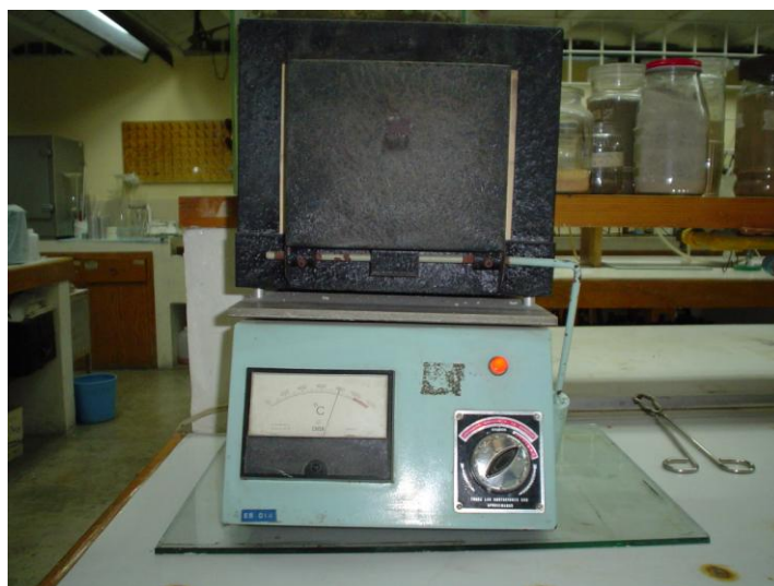
Fig. 3.10 Mufla, para calcinación del sólido residual
