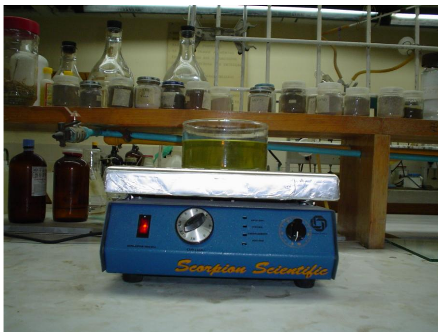
Fig. 3.6 Filtrado en parrilla de calentamiento, para reducir el volumen y tener un mayor éxito en la formación de cristales
