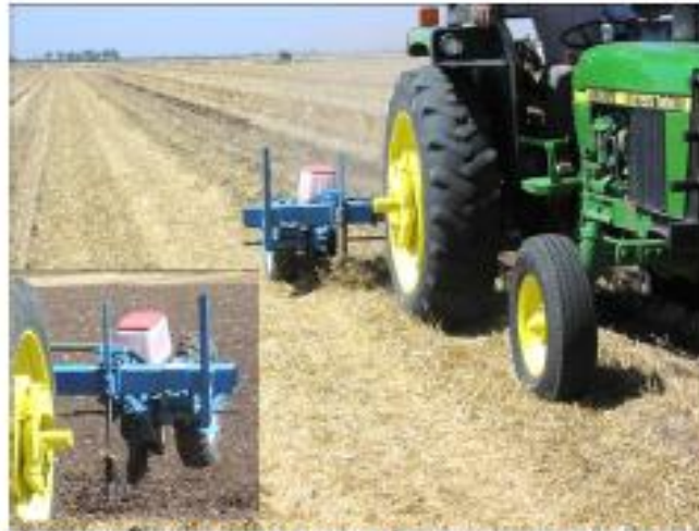
Figura 1. Timón Cawe®, en siembra de maíz de verano sobre paja de trigo en la manzana 609 del Valle del Yaqui, Sonora.
