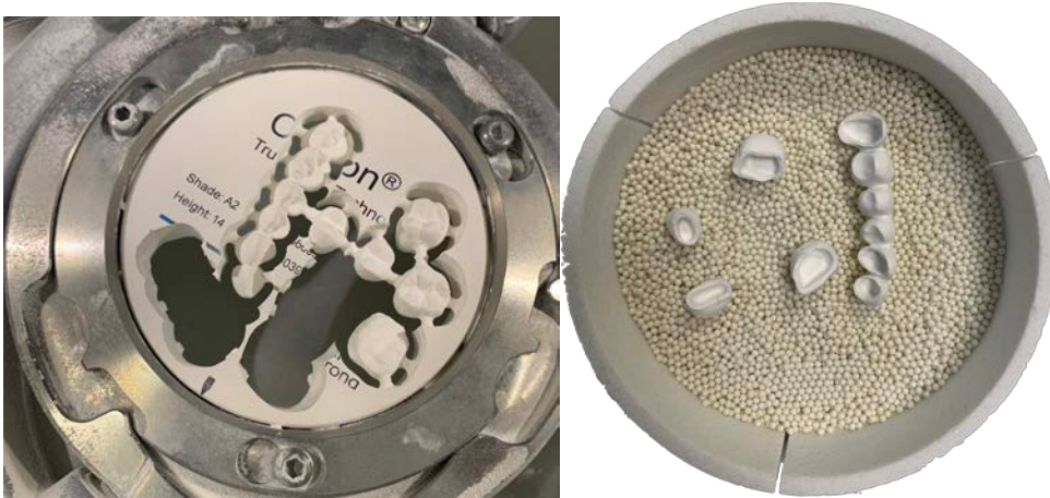
Ilustración 21 Recuperación de restauraciones pre-sinterizadas
