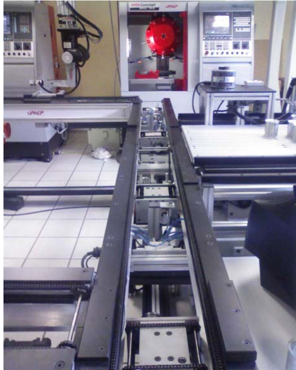
Figura 3.9. Bandas transportadoras y elevadores para estaciones.
