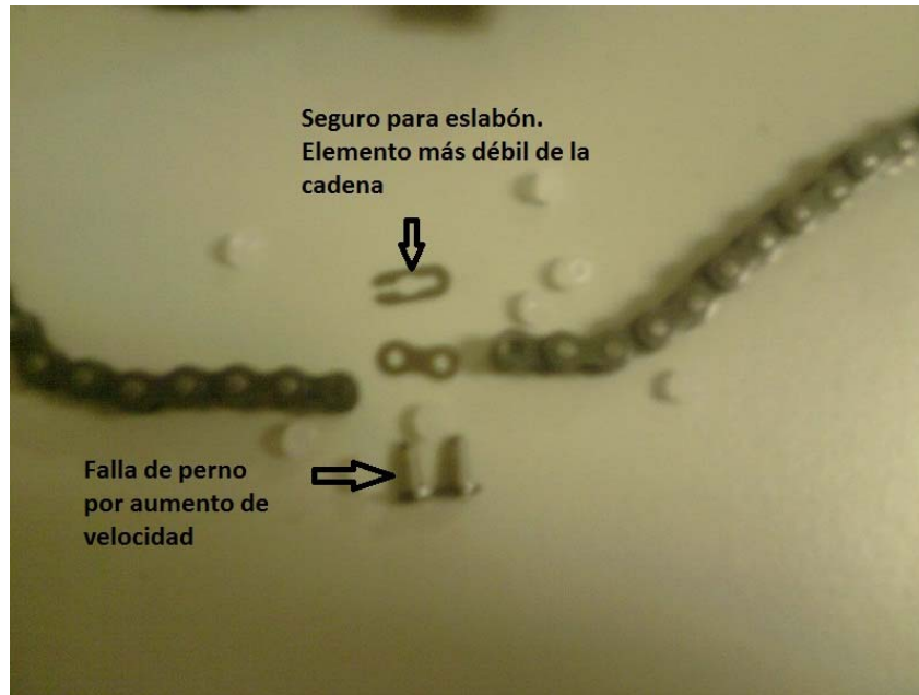
Figura 4.1. Rompimiento de cadenas por esfuerzos a máxima velocidad en bandas.
