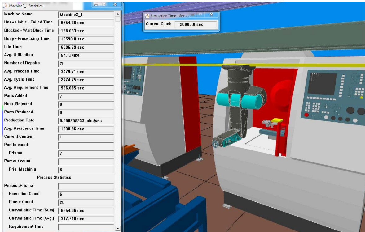
Figura 4.10. Resumen de datos al final de la corrida y el estado final en la fresadora CNC en el modelo con fallas probabilísticas.
