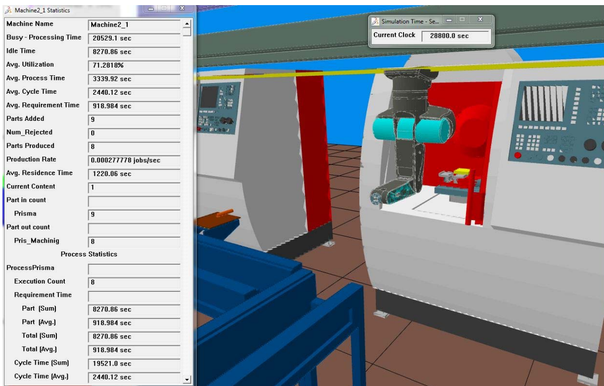
Figura 4.8. Resumen de datos al final de la corrida con fallas programadas con distribución de probabilidad y el estado obtenido para la fresadora CNC.
