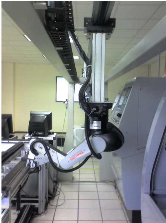
Figura 3.8. Robot y riel en montaje tipo gantry del FMS de UPAEP.
