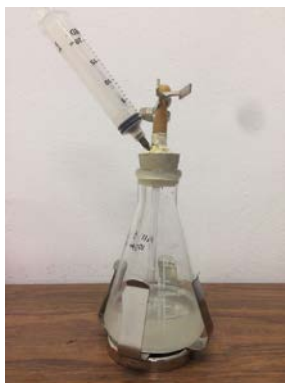
Figura 11. Ejemplo de bioreactor elaborado y utilizado en las pruebas de biodegradabilidad.
