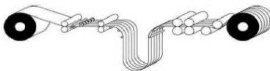
Figura 2.6 Principio de funcionamiento básico de corte a cintas.
