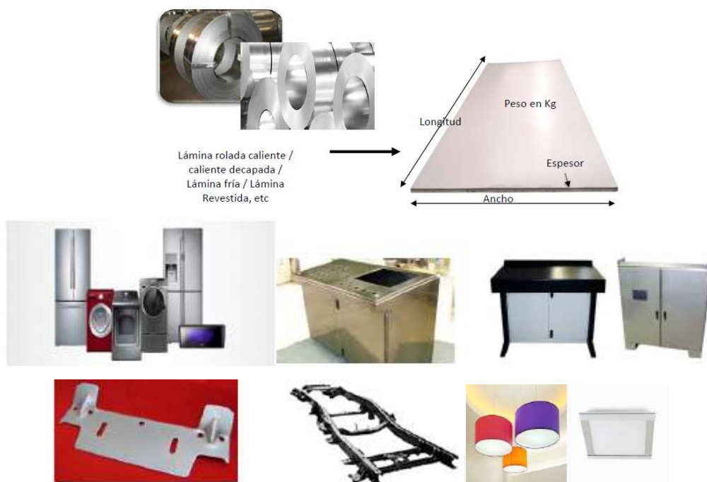
Figura 2.8 Ejemplos de hojas de acero y aplicaciones.
