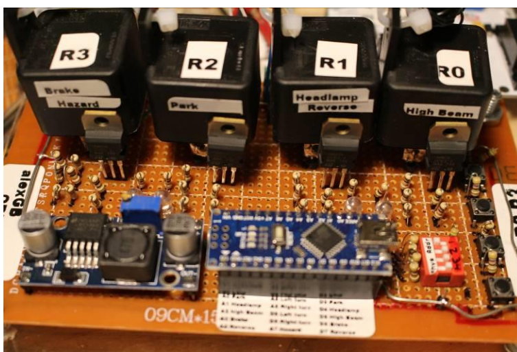
Figura 6.7.2.3 – Relays y sus mosfets junto al procesador
