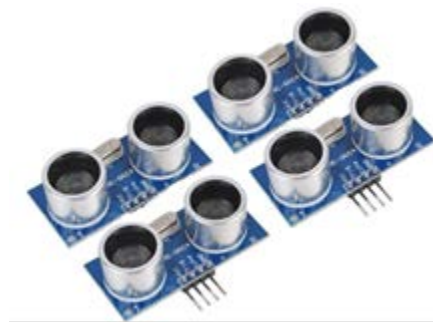
Fig.11. Sensores ultrasónicos utilizados en el robot
