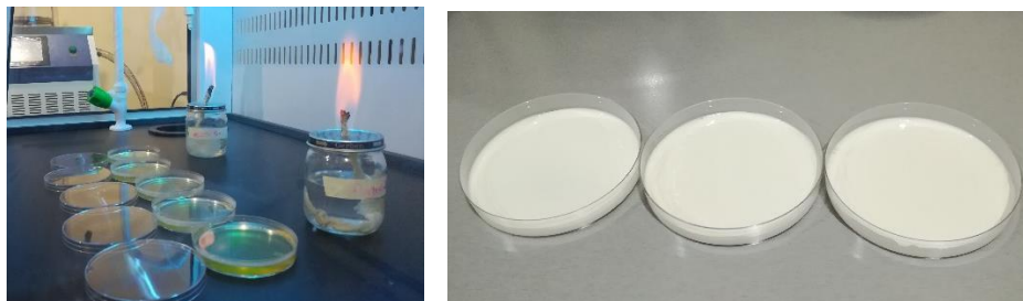
Figura 59: Esterilizado de agar y enfriamiento del látex
