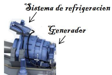
Fig. 2.7 Sistema de refrigeración
